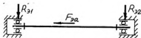
Рис 9.3 Расчетная схема нагружения шариковых подшипников
